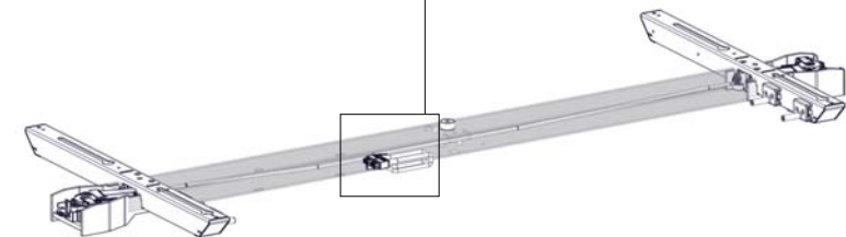
10 Zugentlastung aus Traverse entfernen und Motorkabel entnehmen
