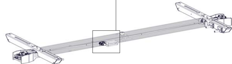
10 trekontlasting uit de dwarsbalk verwijderen en motorkabel uitnemen
